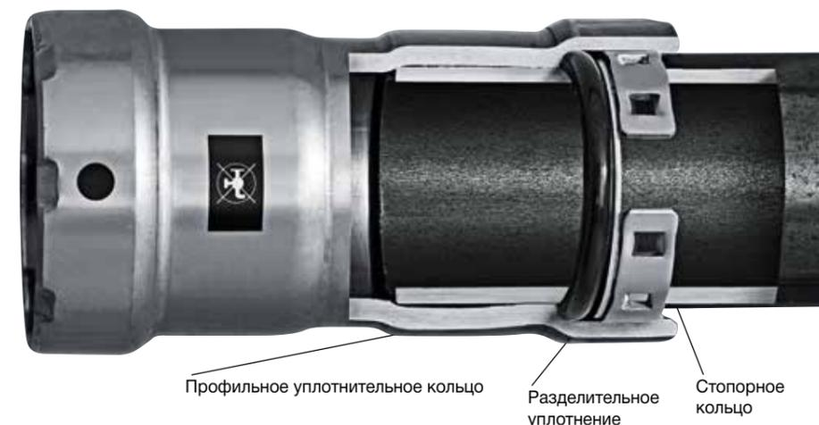
*Разделительное уплотнение перед уплотнительным кольцом предотвращает его повреждение при вводе трубы. При опрессовке стопорное кольцо входит в трубу и обеспечивает соединению особую надежность.*
