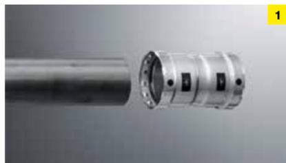
1 **Стальная труба обрезается по размеру и очищается. Затем измеряется и размечается глубина вставки. После этого фитинг Viega Megapress устанавливается на трубу до сделанной отметки.**
